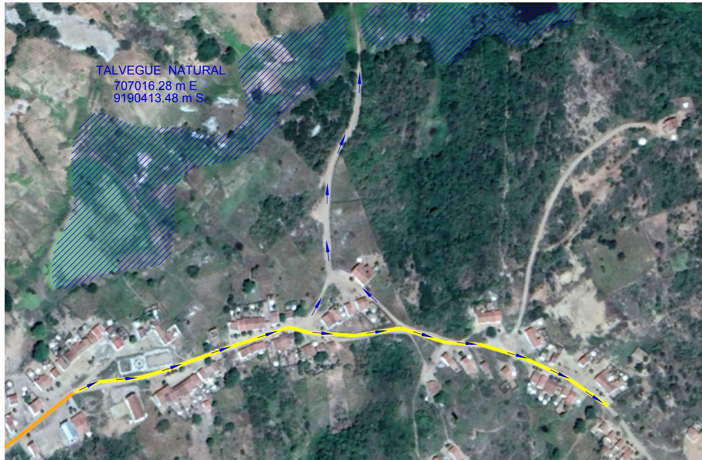
Mapa de Destino final das Águas Pluviais da Rua Projetada 01 escala 1:1000
